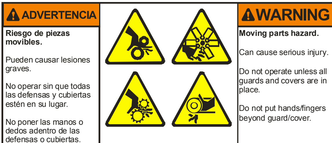
Figura 2: Peligros eléctricos y mecánicos internos—Piezas en movimiento detrás de las defensas y las cubiertas
