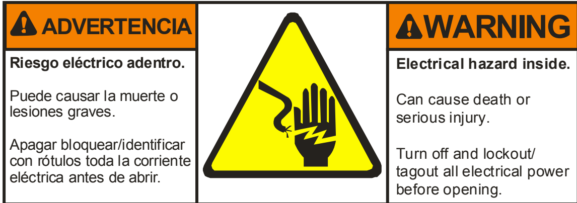
Figura 1: Peligros eléctricos y mecánicos internos—Electricidad
