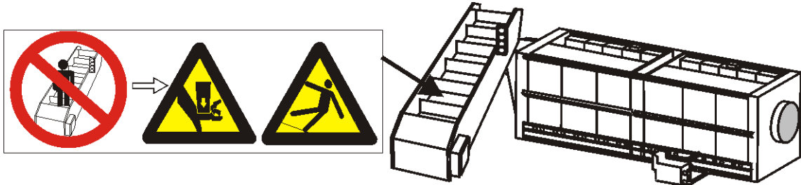
Figura 1: Peligros Mecánicos Externos
