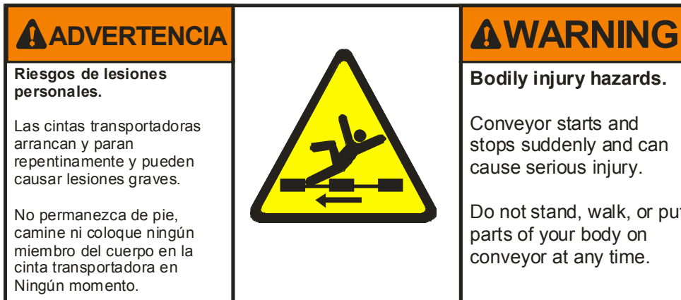
Figura 4: Peligros Mecánicos Externos—Inicio y detención de la faja transportadora
