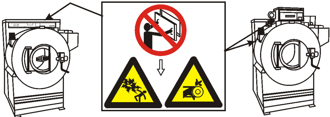
图 2: 机器内部电及机械危险
