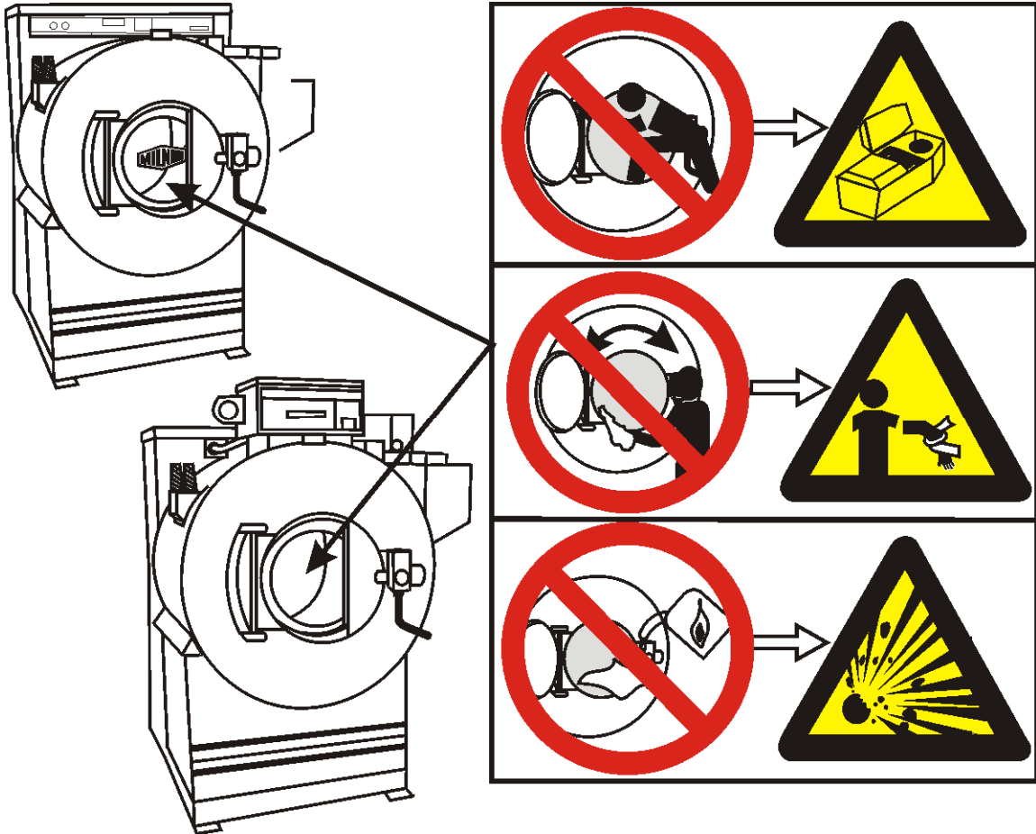
Illustration 4: Risques du tambour et du fonctionnement
