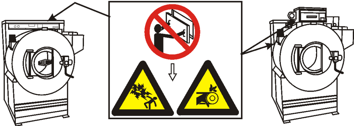
Illustrazione 2: Rischi elettrici e meccanici interni
