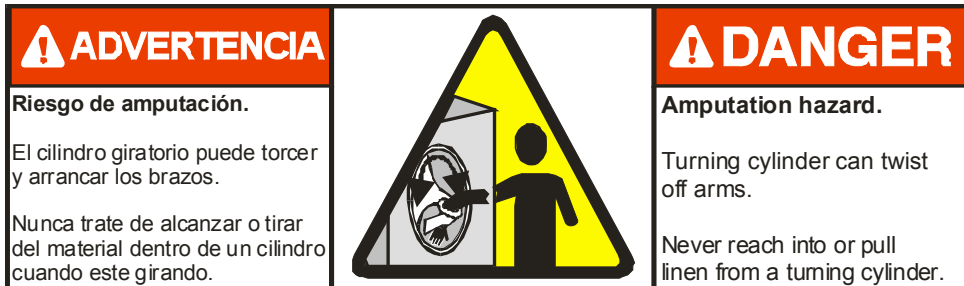
Figura 5: Peligros del cilindro y del proceso—Cómo tomar prendas en la máquina
