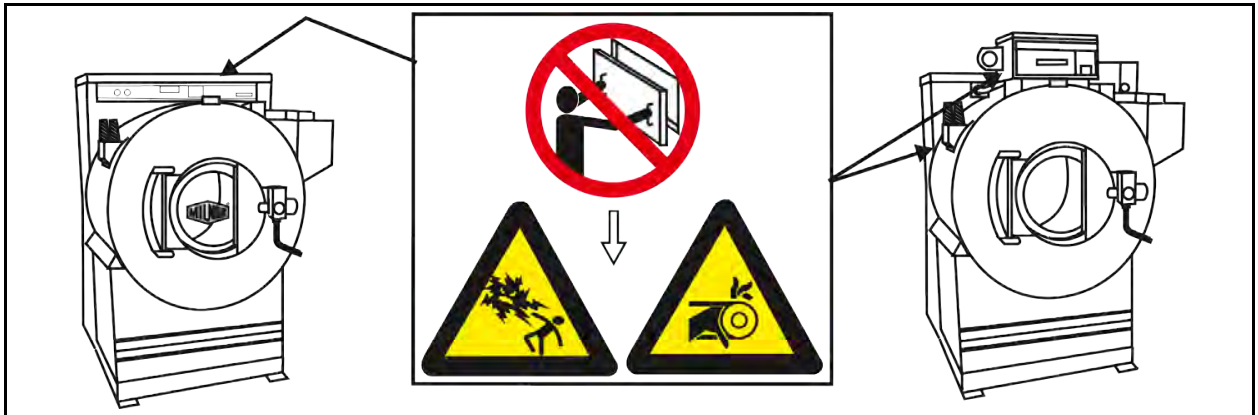
Ilustración 2. Riesgos electromecánicos internos
