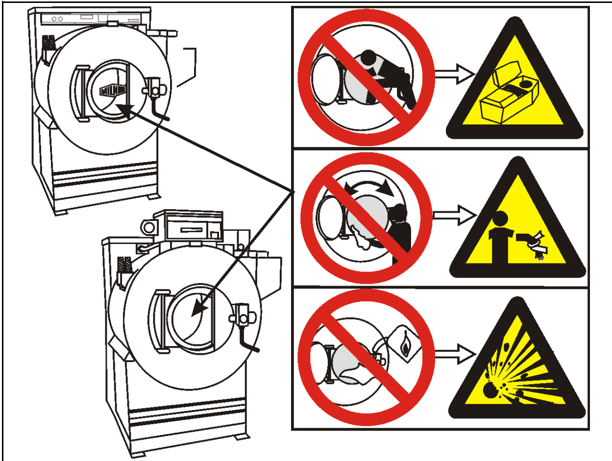
Figure 4. Risques liés au cylindre et au traitement
