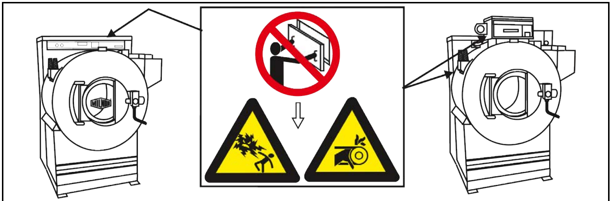
Figure 2. Risques électriques et mécaniques internes
