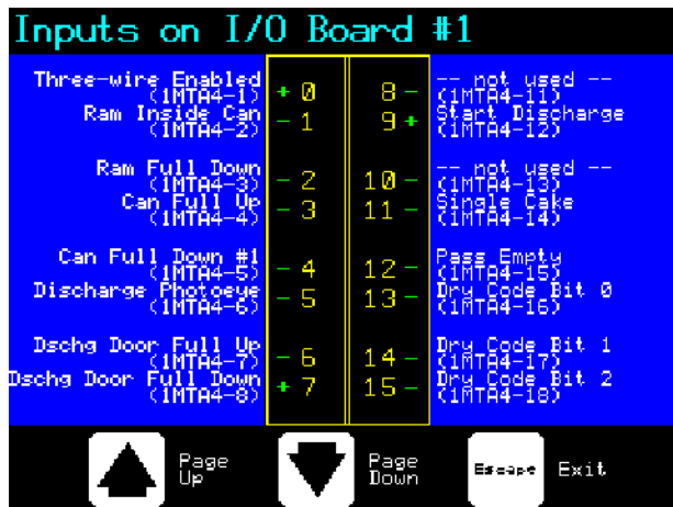
Abbildung [Figure] 26: Typische Eingangsanzeige für E/A-Platine [Typical Inputs Display for Input/Output Board]
