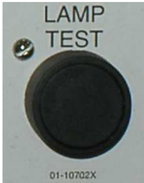
Afbeelding 6: Schakelaar Lamp test
