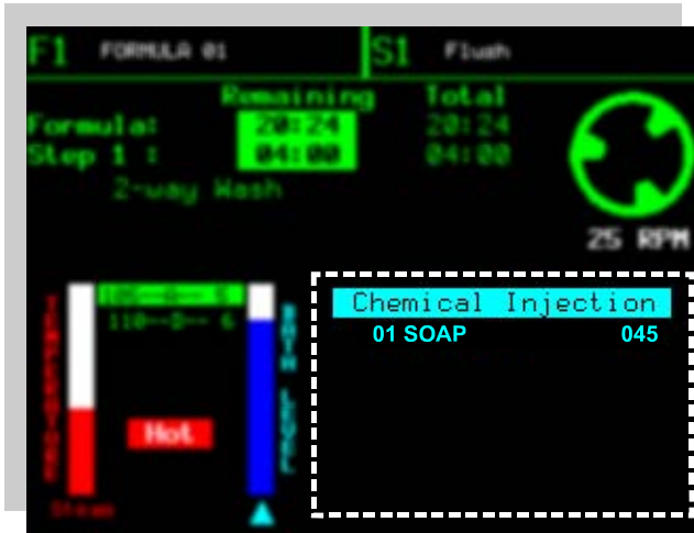
Rakam [Figure] 17: Çalıştır ekranında Kimyasal enjeksiyon Görünümü [Chemical Injection View on Run Display]
