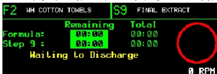
Obrázek [Figure] 15: Typická zpráva když program skončí [Typical Message when Formula Ends]
