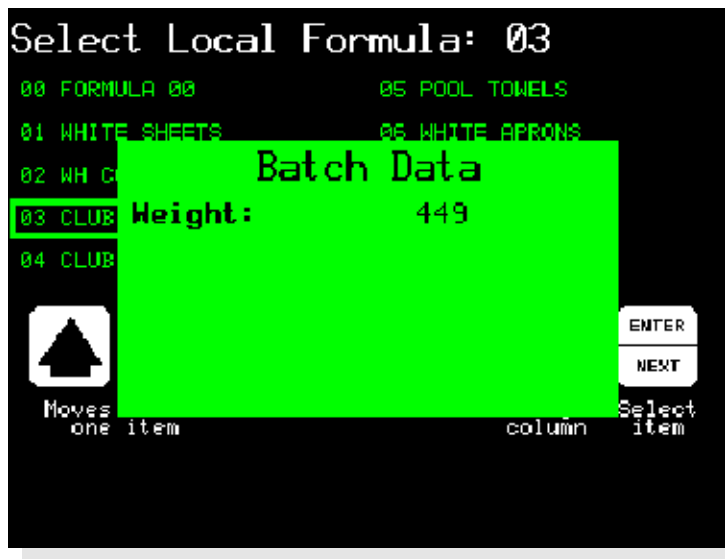
Obrázek [Figure] 11: Zapisování váhy nákladu pro měřenou vodu [Entering Load Weight for Metered Water]
