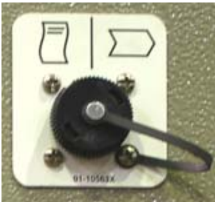
Abbildung [Figure] 2: Serielle Anschluss für den Datenaustausch [Serial Connection for Data Transfer]
