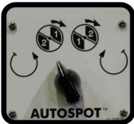
Imagem 7: Interruptor seletor de Autospot
