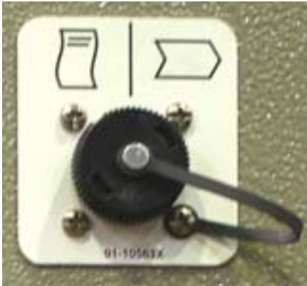
Figur 2: Serietilslutning for dataoverførsel
