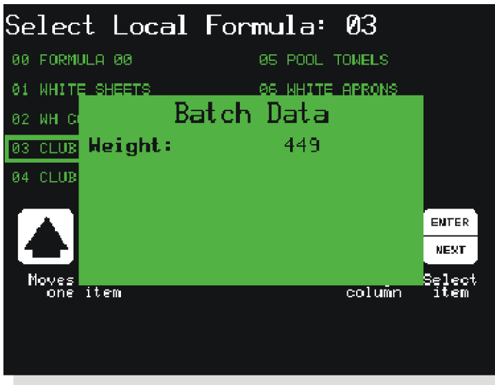
Figura 10: Registrando el peso de la carga en máquinas con contador de agua
