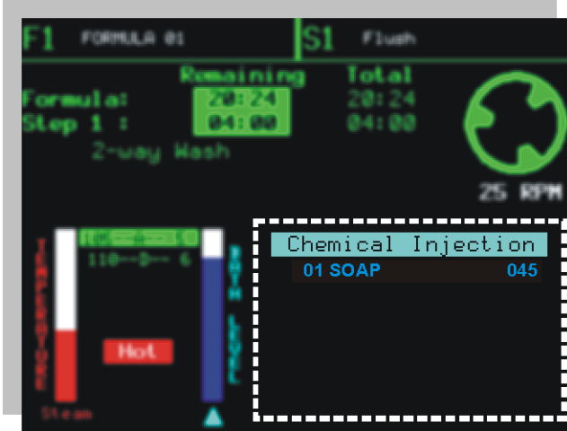
Figura 16: Vista de la inyección del producto químico en la pantalla de correr
