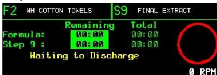
Illustration [Figure] 15: Message typique affiché à la fin de la formule [Typical Message when Formula Ends]
