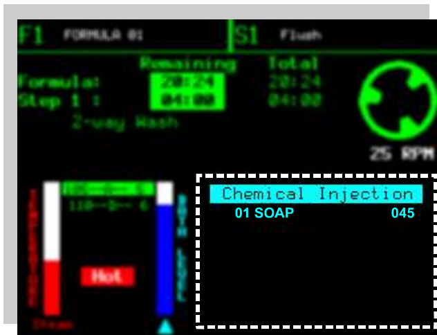
Illustration [Figure] 17: Injection des produits chimiques : Ecran de visualisation du déroulement du programme [Chemical Injection View on Run Display]
