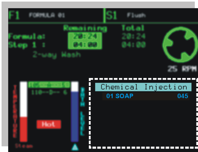
Kuva [Figure] 17: Kemikaalien lisäysnäkyvä Run (Käyttö) -näytössä [Chemical Injection View on Run Display]
