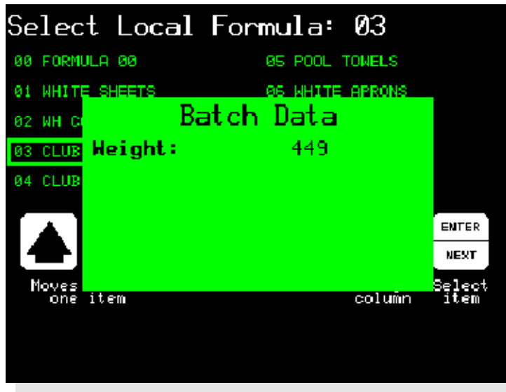
Illustration [Figure] 11: Introduire le poids de la charge pour le débitmètre [Entering Load Weight for Metered Water]
