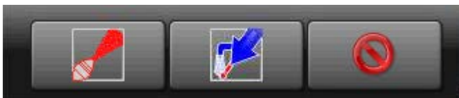
Abbildung 18. Popup-Steuerelemente für Dampf- und Kühlwasserventile
