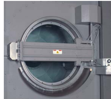
Abbildung 6. Hydraulisch betriebene Automatiktür
