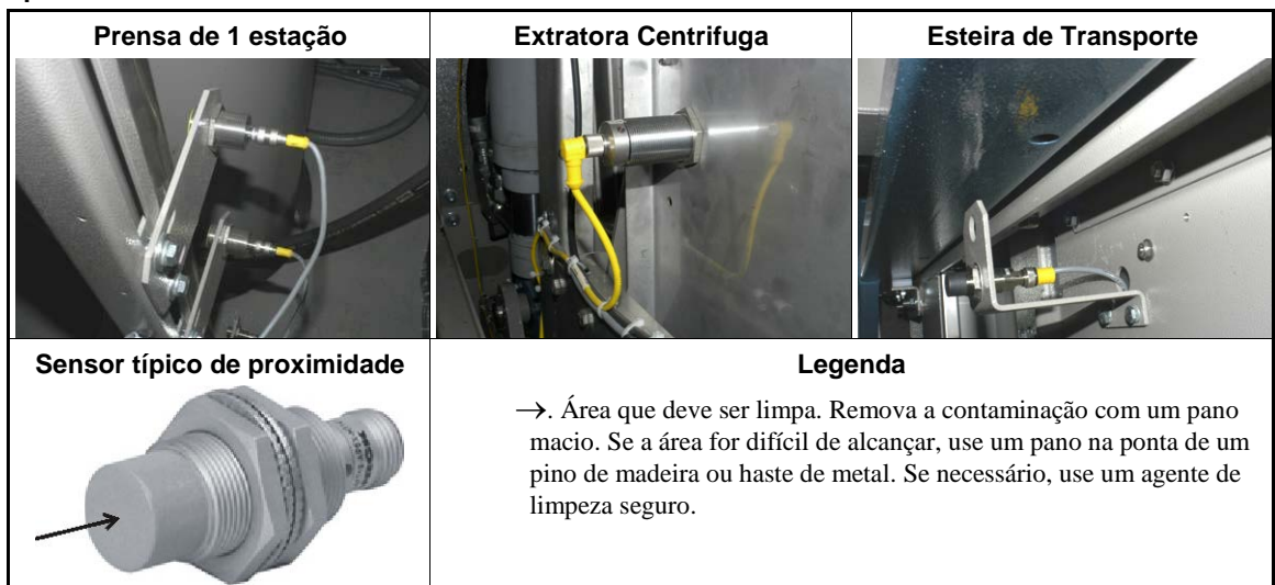
Imagem 5: Sensores de proximidade Estes são apenas exemplos. Sua máquina pode ter outra aparência.
