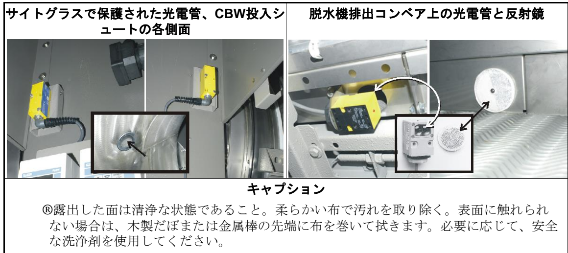
図 11: 光電管。以下の写真は例です。ご使用の機械と異なる場合があります。
