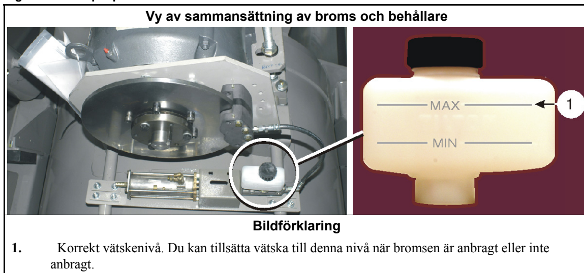
Figur 17: Exempel på skivbroms. Er maskin kan se annorlunda ut.
