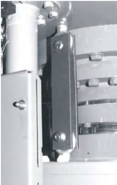
Illustration 4: Chandelles de sécurité pour modèles de presse à 1 station (déployées sur l'illustration de gauche, rangées sur l'illustration de droite)
