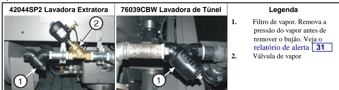
Imagem 10: Filtro de entrada de vapor. Estes são apenas exemplos. Sua máquina pode ter outra aparência.
