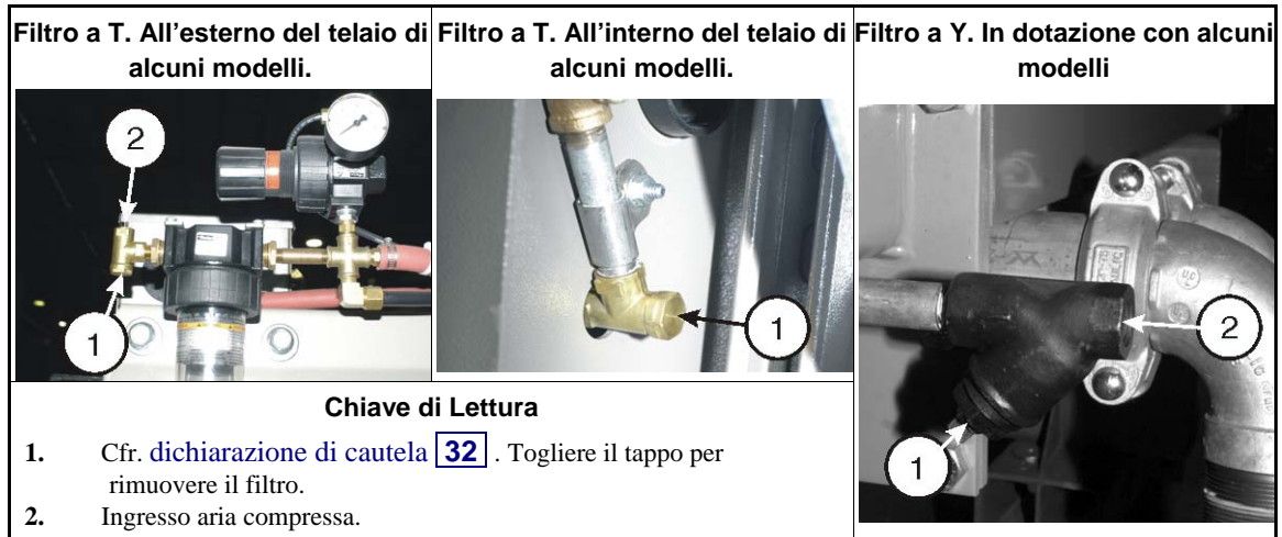
Illustrazione 11: Filtri di aria compressa in ingresso. Sono esempi. L'apparecchio può discostarsi dal modello proposto
