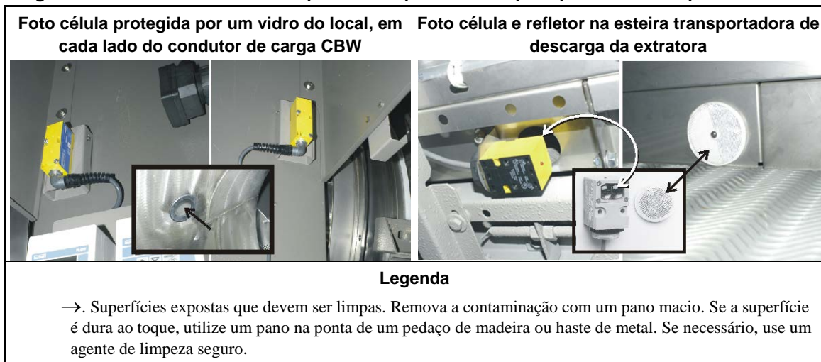
Imagem 14: Foto células. Estes são apenas exemplos. Sua máquina pode ter outra aparência.
