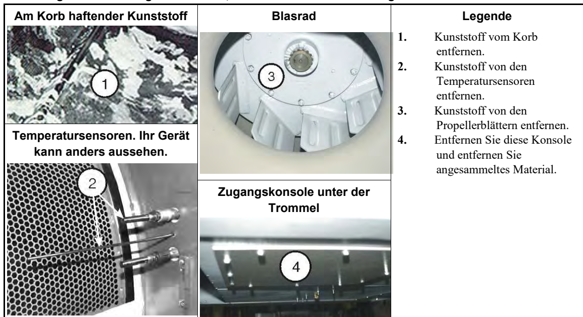
Abbildung 19: Entfernung von Material, das mit den Artikeln hereingekommen ist
