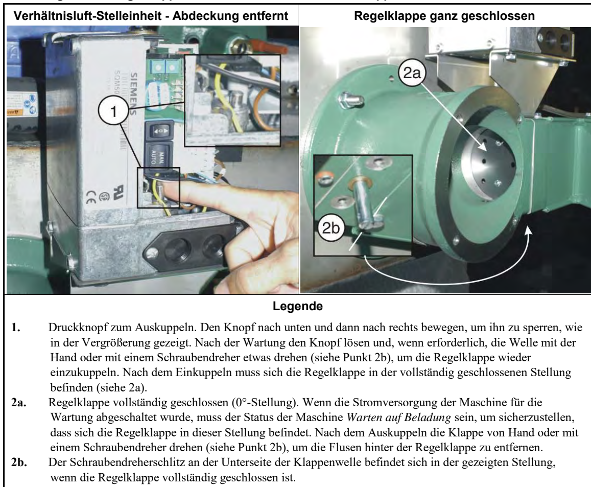
Abbildung 17: Die Regelklappe zum Entfernen der Flusen auskuppeln
