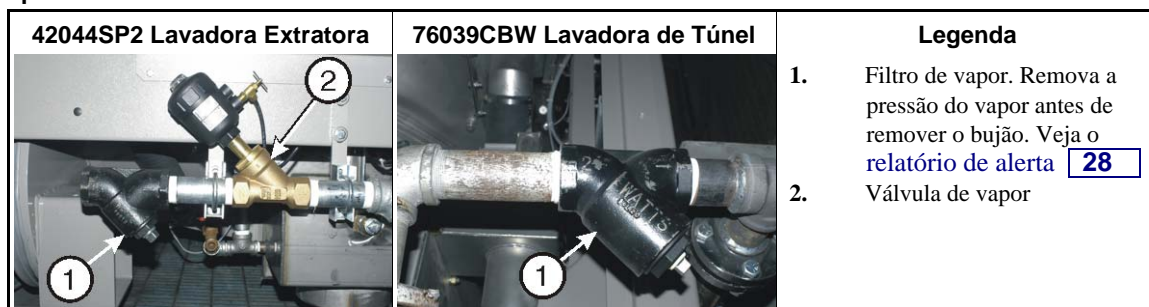
Imagem 12: Filtro de entrada de vapor. Estes são apenas exemplos. Sua máquina pode ter outra aparência.
