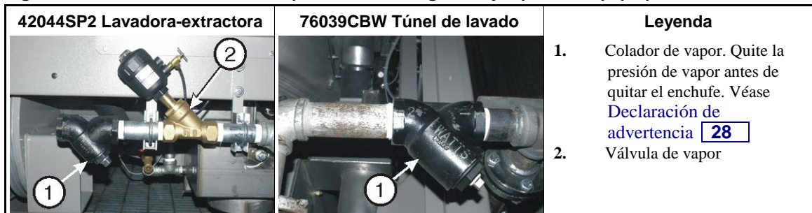
Figura 12: Colador de entrada de vapor. Estos son algunos ejemplos. El equipo puede ser diferente.
