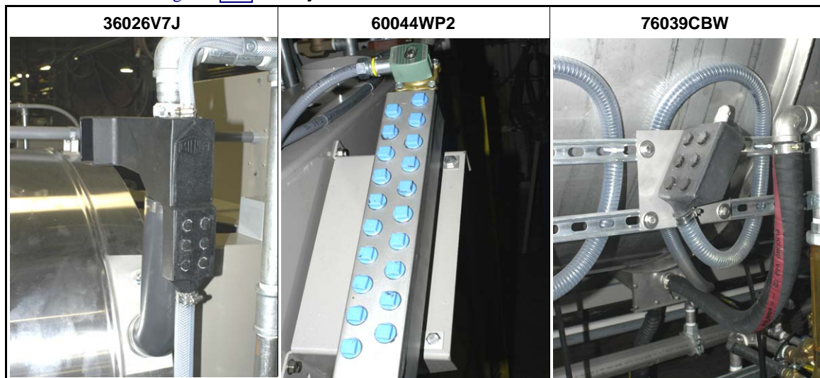
Abbeelding 9: Chemische inlaatverdelers voor pompsystemen voor chemicaliën. Zie verklaring betreffende voorzichtigheid 25 . Dit zijn voorbeelden. Uw machine kan er anders uitzien.
