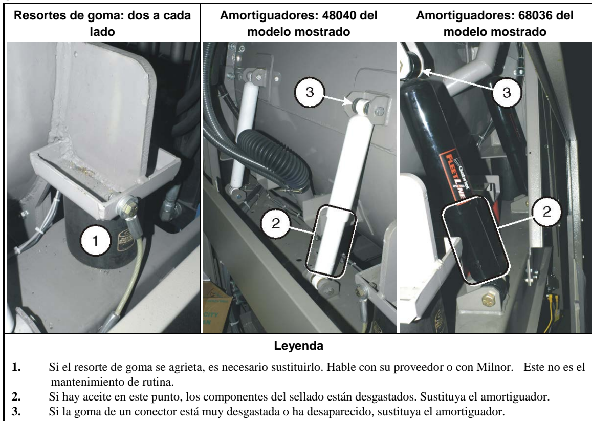
Figura 15: Componentes de la suspensión a cada lado de la lavadora-extractora sobre resortes de goma (consulte Complemento 3 )
