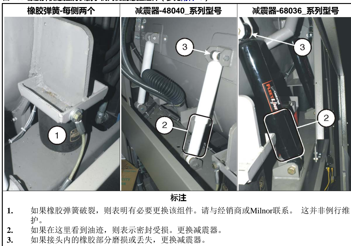
图 15: 橡胶弹簧悬挂洗衣脱水机两侧的悬挂组件 (参见附件 3)
