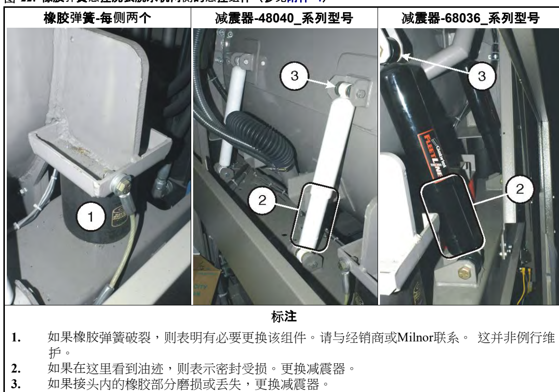
图 22: 橡胶弹簧悬挂洗衣脱水机两侧的悬挂组件（参见附件 4）
