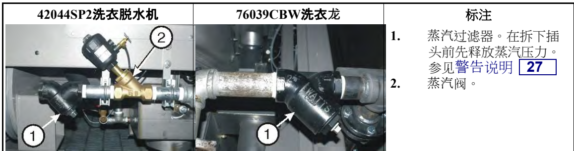
图 14: 蒸汽入口过滤器。以下为例。您的机器可能与此不同。
