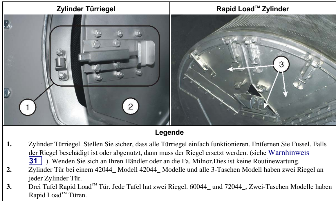
Abbildung 18: Zylinder Türriegel
