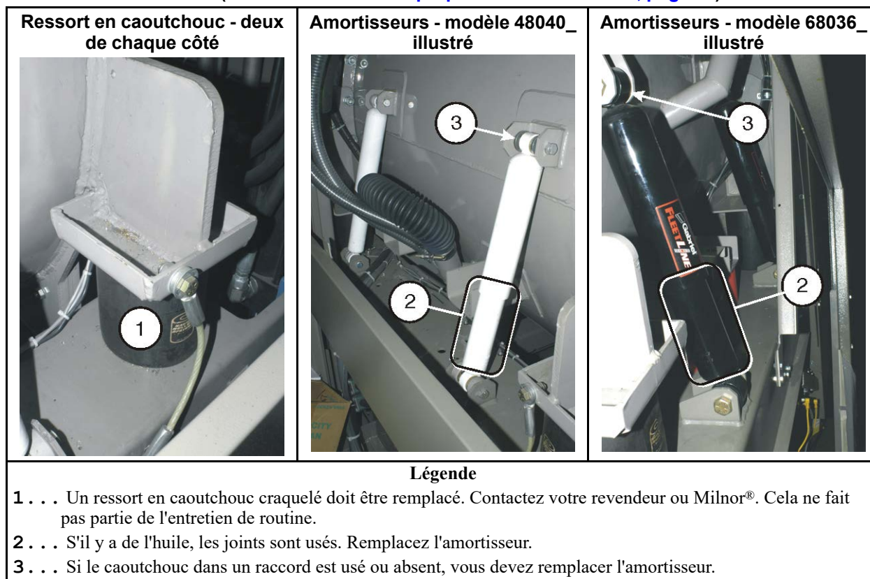
Figure 21. Composants de la suspension de chaque côté de la laveuse-essoreuse reposant sur ressorts en caoutchouc (voir Section 3.3.4 : À propos des amortisseurs, page 39)
