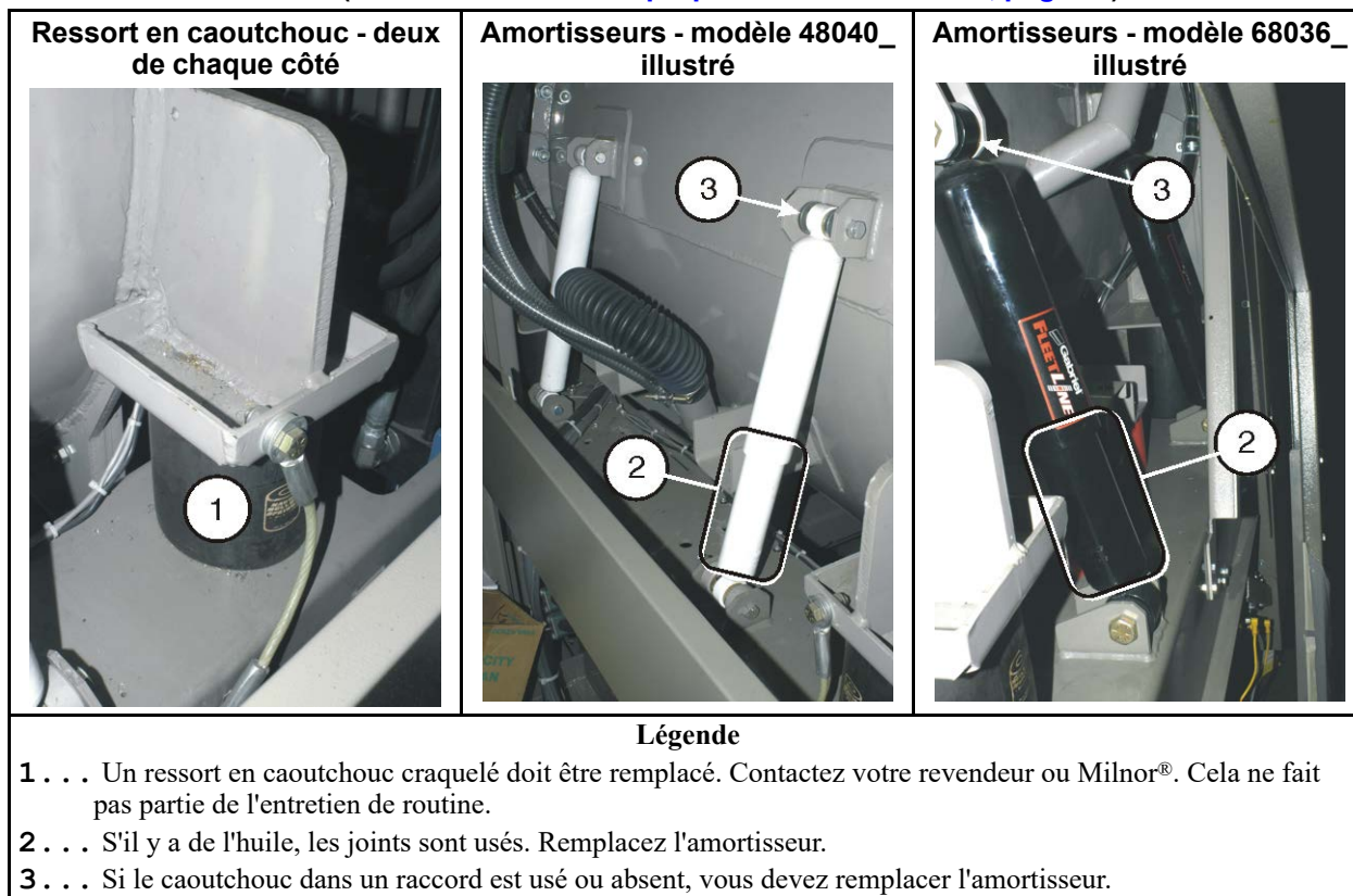
Figure 24. Composants de la suspension de chaque côté de la laveuse-essoreuse reposant sur ressorts en caoutchouc (voir Section 3.3.4 : À propos des amortisseurs, page 44 )
