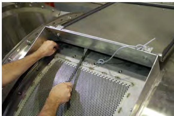
図 1: 内側のハッチナットを外す（表示のG3 CBW。類似のG4。）
