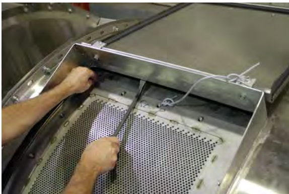
Illustration 1: Retrait des écrous de la trappe intérieure (G3 CBW illustré. Identique pour G4.)
