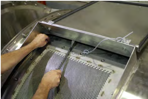
Abbildung 1: Entfernen der Muttern an der inneren Tür (G3 CBW abgebildet. G4 ist ähnlich.)
