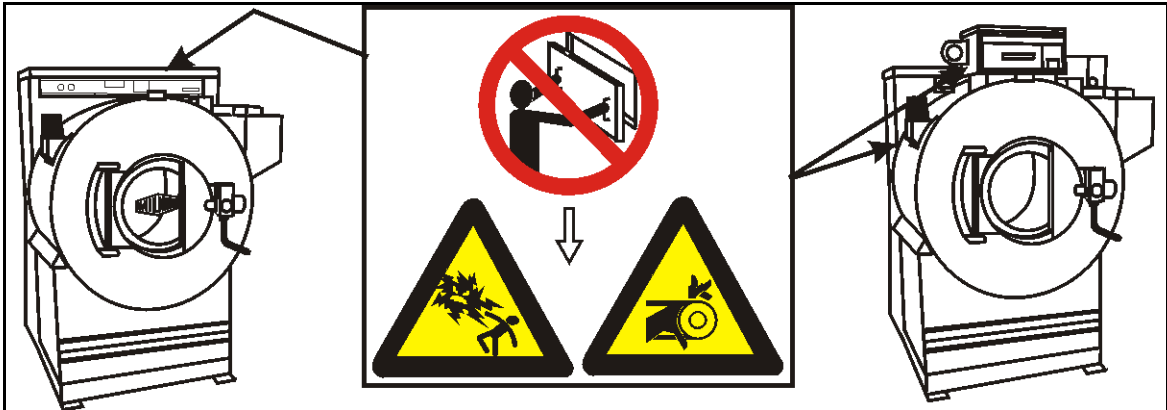
Σχήμα 2: Κίνδυνοι στο εσωτερικό του μηχανήματος λόγω ηλεκτρικών και μηχανικών αιτιών
